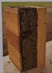
Isolation thermique avec du liège
