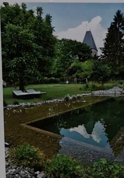
Une piscine biologique utilise des plantes aquatiques pour filtrer l'eau, éventuellement de l'eau pluviale récupérée. Ce principe biologique de lagunage évite l'emploi de produits chimiques ; il s'applique aussi au traitement des eaux usées de collectivités.
